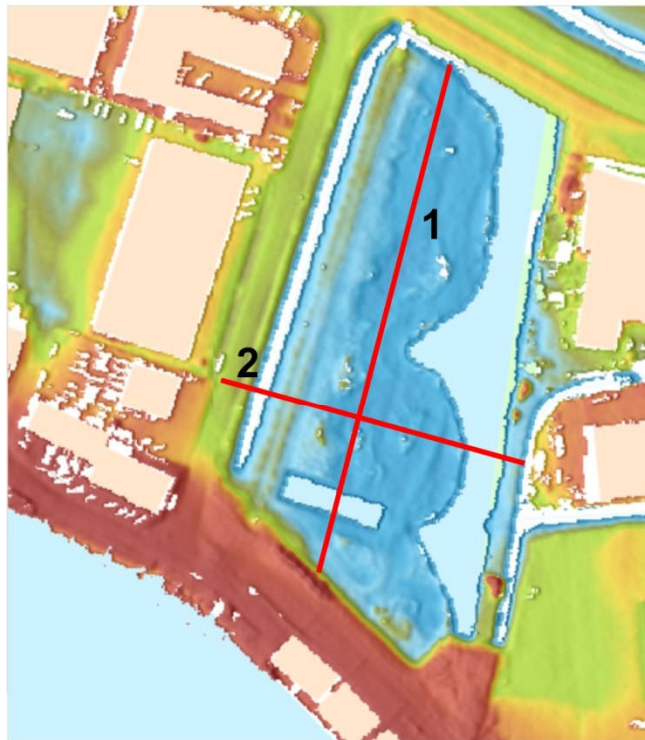
Figuur 6. Twee hoogtedoorsneden (1 en 2) over het natuurterrein langs de Spekhuisstraat. Het terrein ligt ten opzichte van de omgeving tamelijk laag, waardoor het 's winters regelmatig geïnundeerd is met regenwater. Bron: AHN5.
